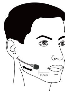
安装一个单指向话筒离嘴角2-3厘米（1英寸），以确保最佳的音质。搭配防风罩可以将风声噪音降低。
